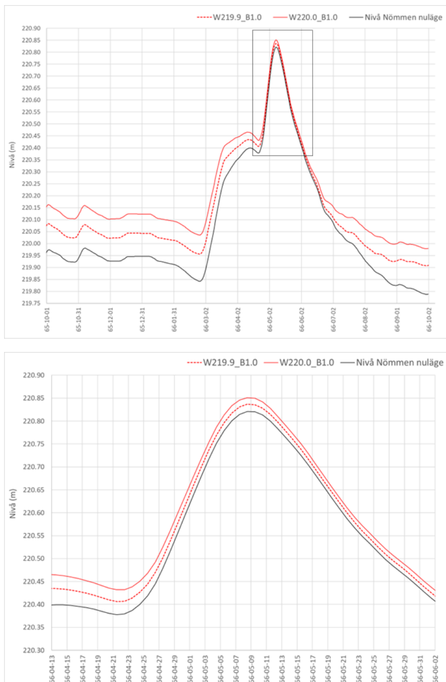
Figur 27. Beräknade nivåer i Nömmen före och efter åtgärd (fallet utan bottenutskov) med en tillrinning hämtad från vårfloden 1966 (överst). Inzoomning till flödestoppen (underst).
