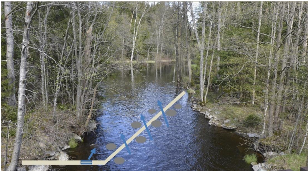
Figur 18. Illustration av flödesutjämnande utskov bestående av en högflödesväg över ett skibord (höger) och en lågflödesväg med bottenutskov (vänster). Utskovet har ritats in på sträckan direkt nedströms järnvägsbron. Källa: Emåförbundet.
